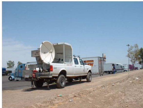
Figuur 5. het mobiel radarsysteem van de universiteiten van Oklahoma en Massachusetts.
