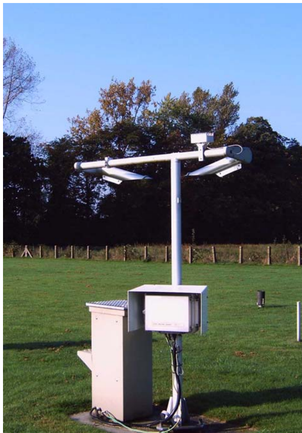
Figuur 2. Present weather station voor de waarneming van zicht en neerslagsoort.
