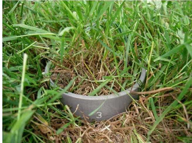
Figuur 3. Een microlysimeter gevuld met gras.
