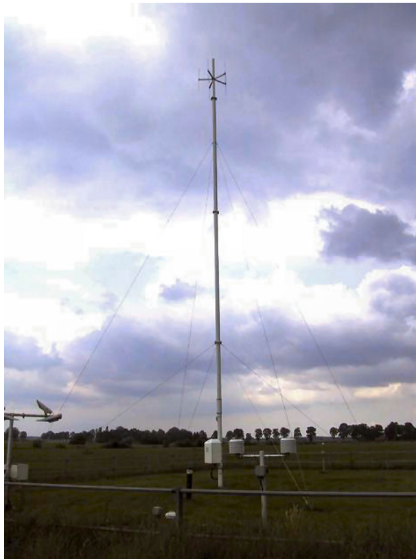
Figuur 1. Bliksemdetectiemast met 5 dipool antennes in de top (foto: Ronald van de Vate, KNMI)
